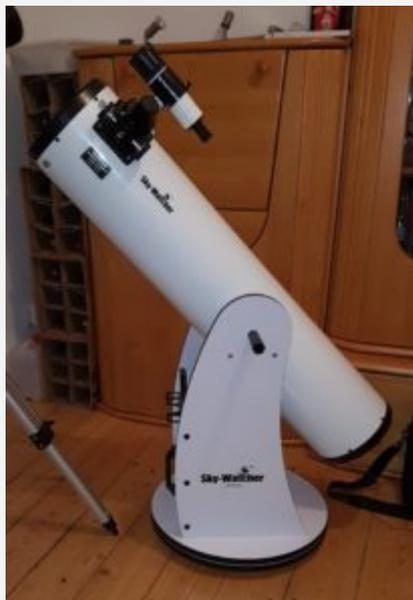
Das Dobson Teleskop von Skywatcher habe ich bei Ebay-Kleinanzeigen für einen fairen Preis erstanden. Zum Teleskop gab es außerdem noch zahlreiches Zubehör (verschiedene Okulare, Webcam, Tasche und einen Lüfter am Teleskop) dazu. Am Teleskop ist noch ein Lüfter unter dem Hauptspiegel angebracht der die Luft dort absaugt und abtransportiert.
